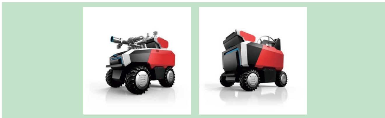
第6-3図 実戦配備型放水砲ロボット及びホース延長ロボットの完成イメージ図
