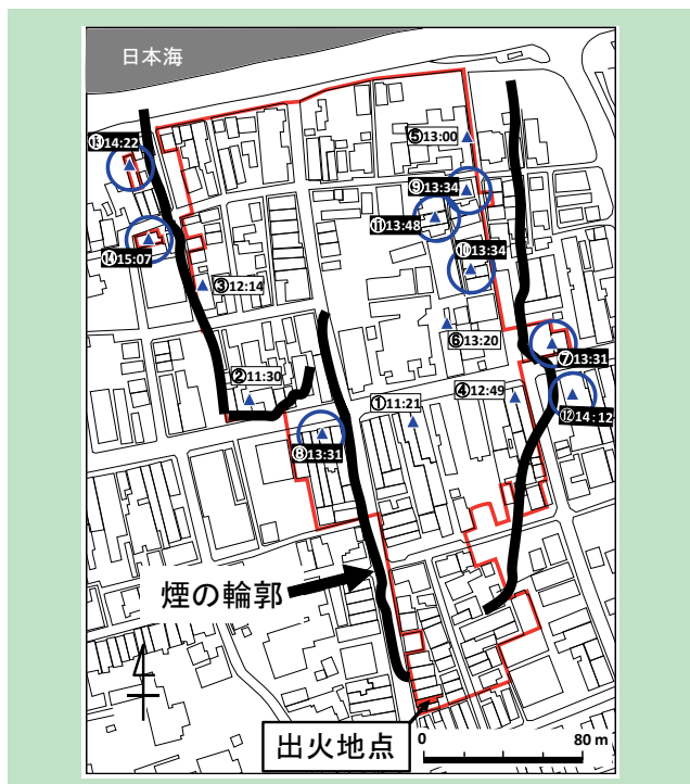
第6-8図 糸魚川市大規模火災での飛火の位置と上空の煙の輪郭
