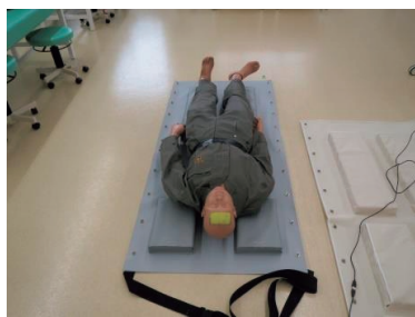
引きずり力の測定用にダミー人形を 乗せて試作した避難補助器具
