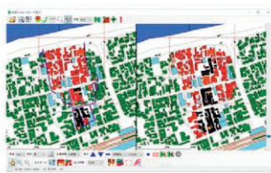
延焼阻止活動の効果の比較（2画面表示） （糸魚川大規模火災での検証例）
