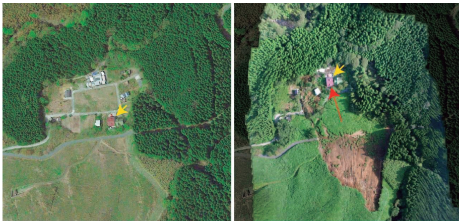
災害発生前：Google Earth [2016年4月15日撮影] 災害発生後：Phantom3 [2016年7月29日撮影] (備考) 災害発生後の画像はドローンにより撮影した写真を用いて作成している。矢印で示した家屋が、災害後約70m移動している。
